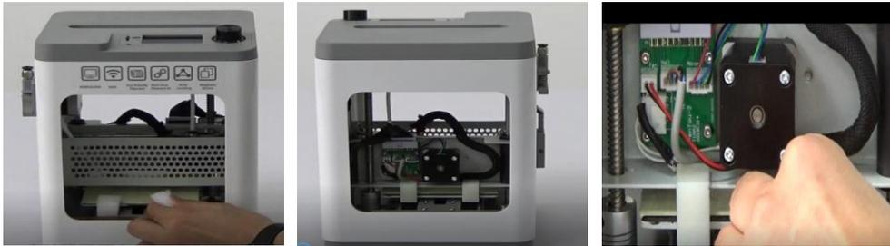
取出打印机, 将机器平台前方和后方的珍珠棉取出,完成此步骤后,取下 X 轴与平台之间的固定扣。
