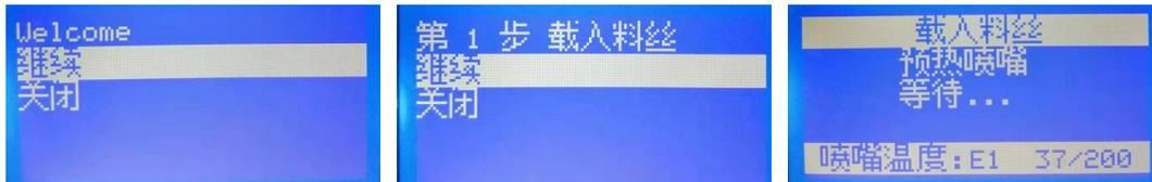
将料丝弯曲的部分剪掉，保证料丝笔直，压紧挤出器手柄，将料丝通过进料口进入到料管，直至料丝靠近喷嘴
