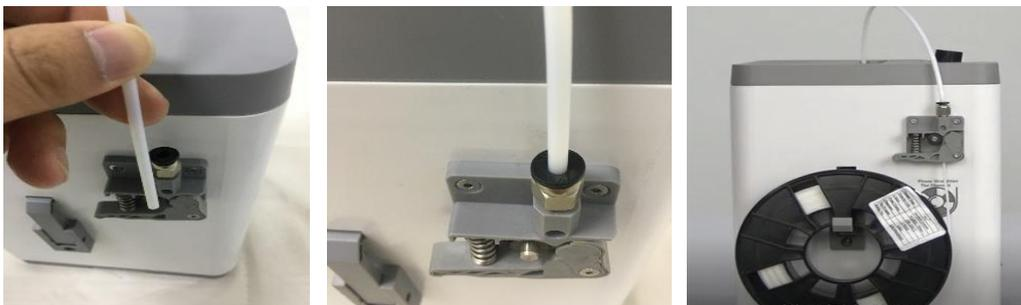
插入进料管, 将料丝挂在机器侧面。
